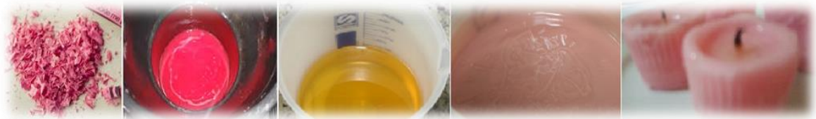
Fig. 2. Processo de derretimento e mistura do óleo com parafina e ácido esteárico, juntamente com o processo final
